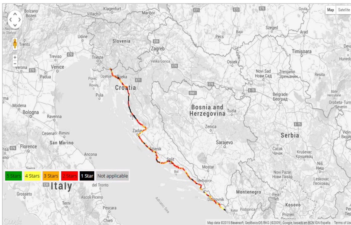
Slika 33. Kartografski prikaz utvrđenih RPS ocjena na dionicama državne ceste D8 nakon provedbe predloženih mjera sanacije (pješaci)
