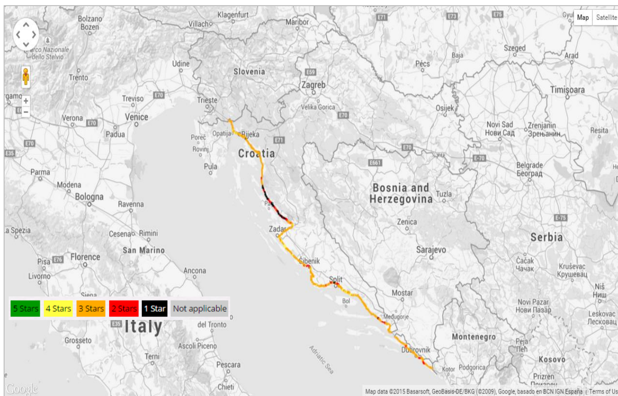
Slika 32. Kartografski prikaz utvrđenih RPS ocjena na dionicama državne ceste D8 nakon provedbe predloženih mjera sanacije (motociklisti)
