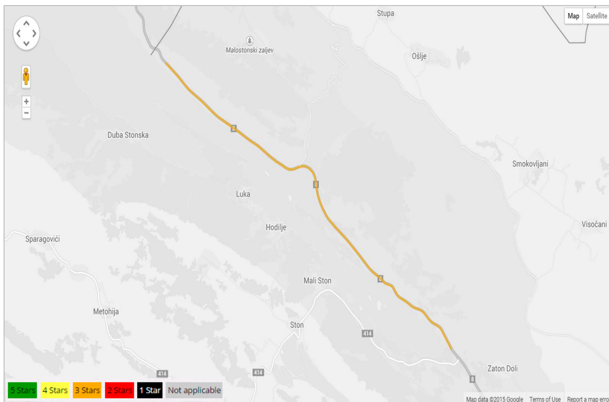
Slika 44. Kartografski prikaz procijenjenih RPS ocjena na dionici 25 državne ceste D8, GP Zaton Doli (gr. R. BiH) – Zaton Doli (D414), nakon provedbe predloženih mjera sanacije
