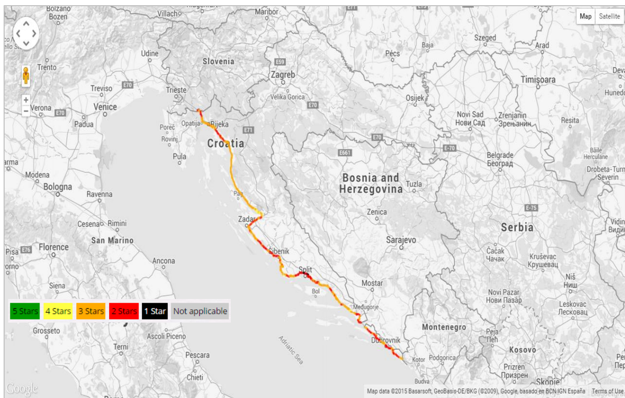
Slika 34. Kartografski prikaz utvrđenih RPS ocjena na dionicama državne ceste D8 nakon provedbe predloženih mjera sanacije (biciklisti)
