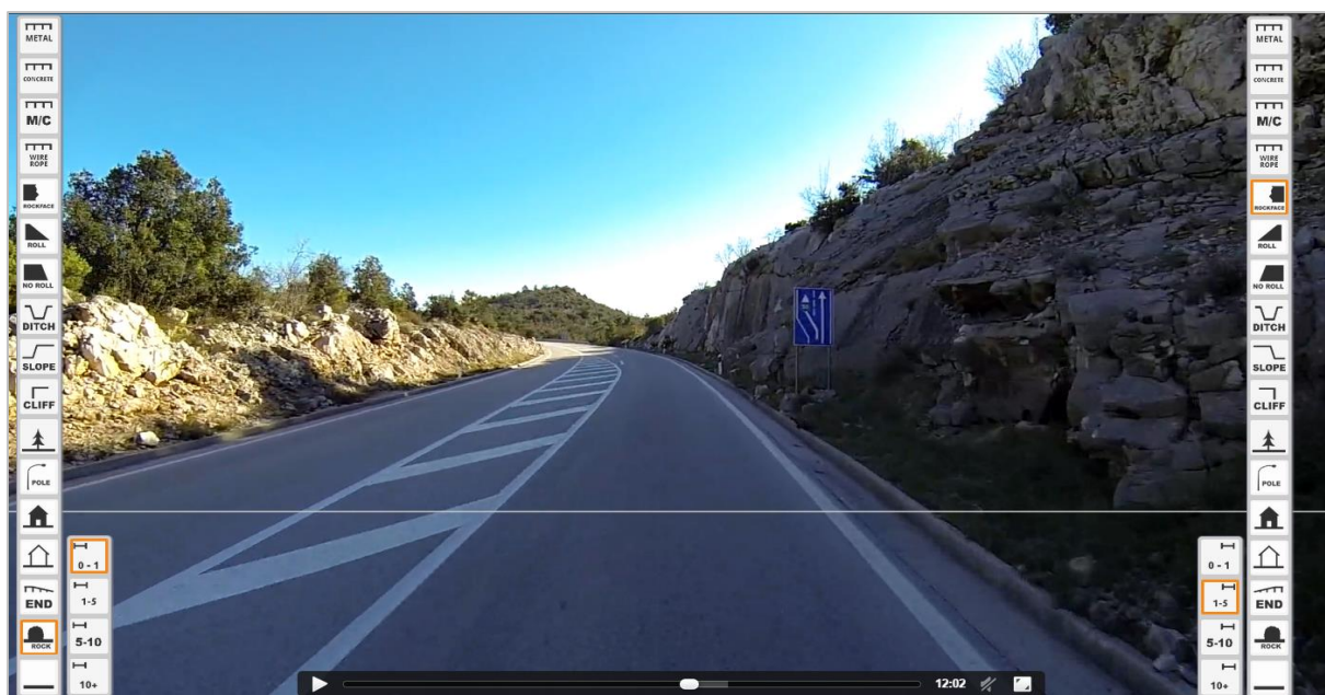
Slika 27. Primjer opasnog mjesta s izbočenom stijenom na desnoj strani ceste u zavoju
