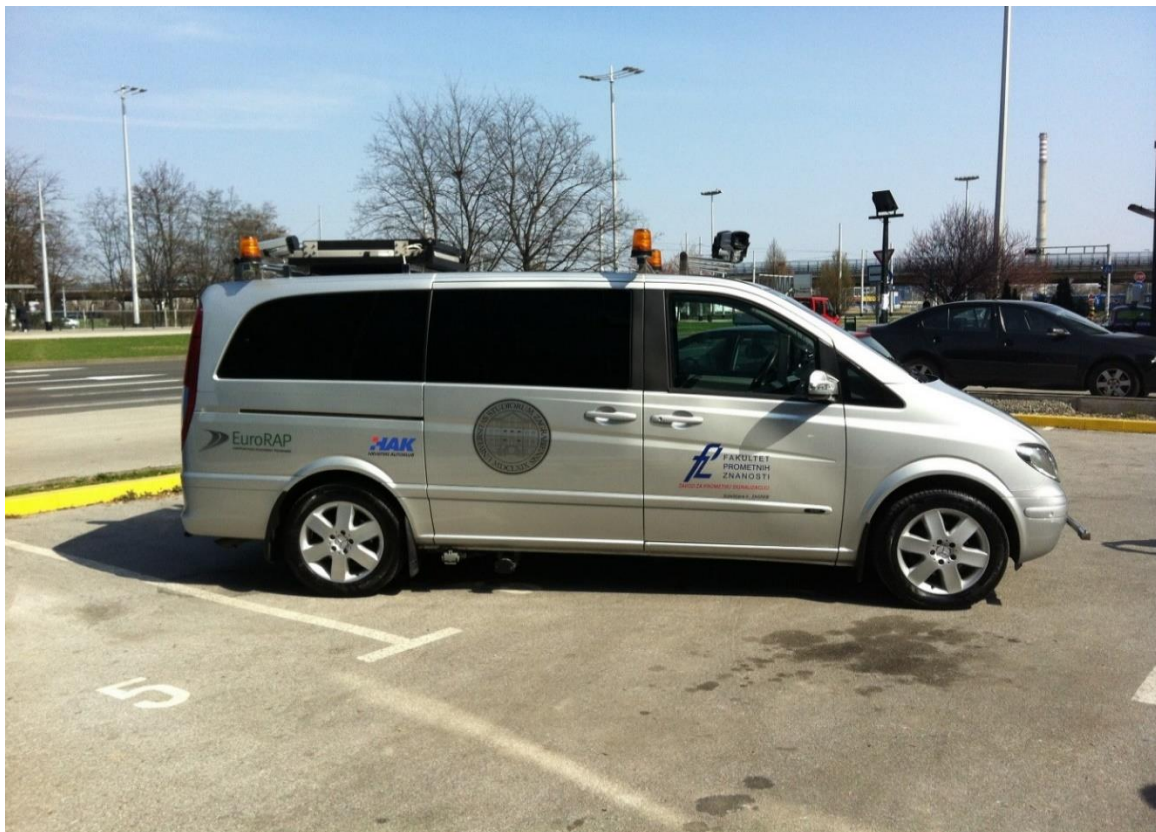
Slika 3. Vozilo za inspekciju cestovne mreže
