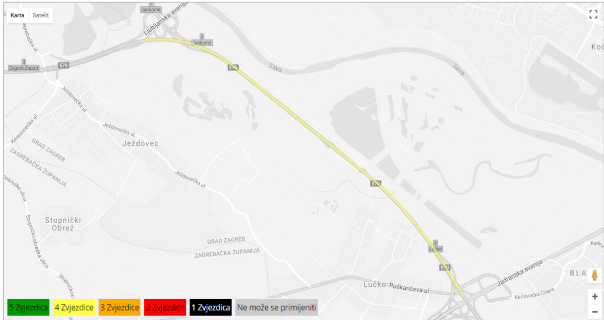
Slika 44. Kartografski prikaz procijenjenih SRS ocjena na dionici A304B autoceste A3 (Lučko - Jankomir), nakon provedbe predloženih mjera sanacije (vozač i putnici osobnog automobila)
