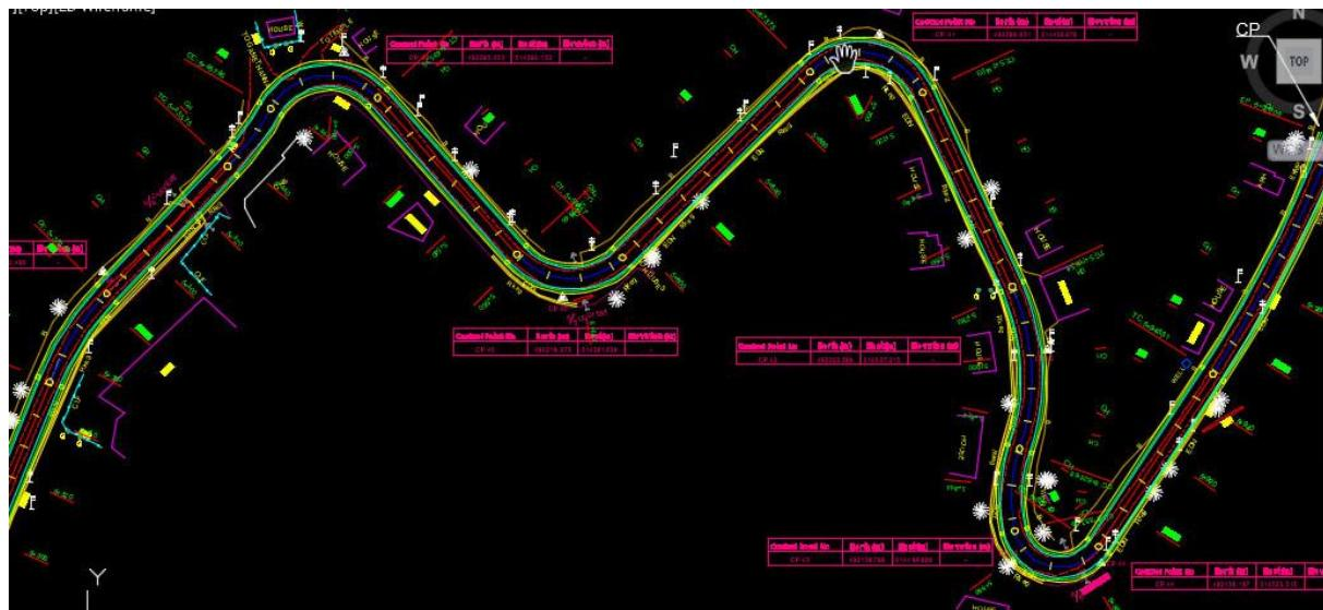
Slika 4 - Primjer tlocrtnih elemenata planirane cestovne infrastrukture primijenjenih za provođenje postupka kodiranja prema SR4D protokolu
