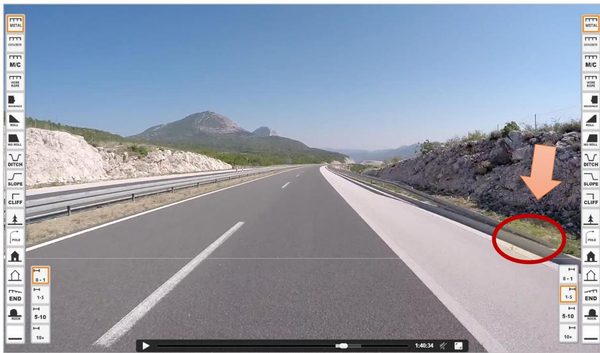
**Slika 23. Primjer opasnog mjesto s nezaštićenim početkom metalne zaštitne odbojne ograde i provaljom na desnoj strani ceste**
