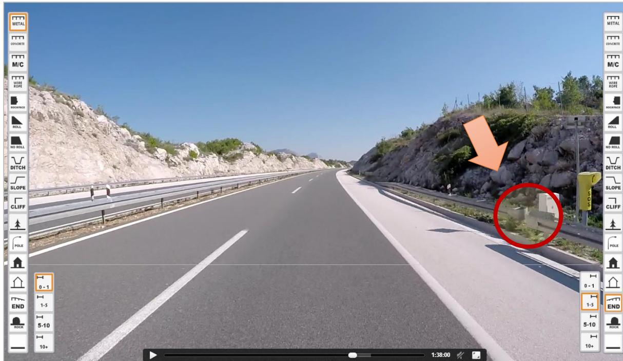
**Slika 24. Primjer opasnog mesta s prekidom u zaštitnoj odbojnoj ogradi**
